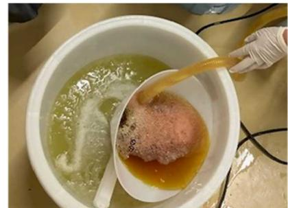
反応槽に移送された脱渋液は速やかに脱色されます
