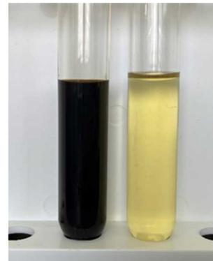
脱渋液(左)と薬液による処理水(右)
