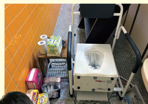
▲避難所に設置された災害用電動トイレ
