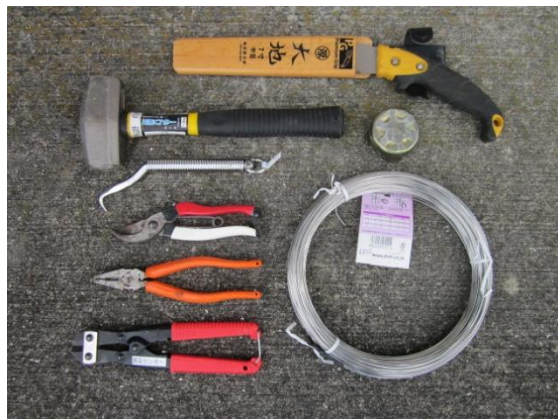
写真1 柵の補修に使用した道具類
