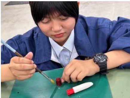
廃棄された鉛の錘をリサイクルして 「オリジナル漁具」を製作
