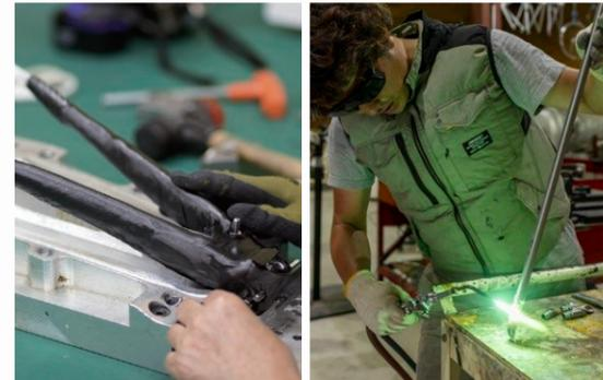
自社工場内では、研究や丁寧な手仕事が行われている。左はフレームの軽量化のため長年研究を重ねるカーボン素材。右は、元の素材を溶かすことなく接合するろう接の作業風景。
