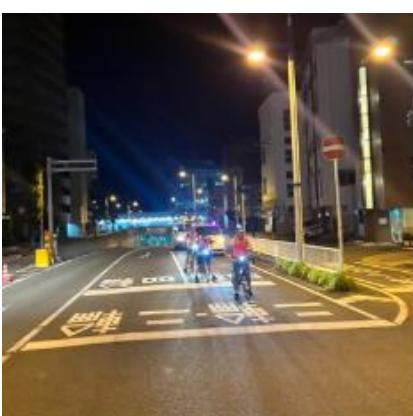
3名の計測員は、先導する車両に追従して、それぞれの間隔を保ちながら隊列となって走行します。前輪がぐらぐらすると運動してカウンターが動き、距離が不正確になってしまふので、常に前輪を安定させて運転しなければならないそうです。自転車を発進させる時や上り坂などは安定を保つのが大変なのだろうですが、計測員のみなさまの熟練した技術によって、終始安定した自転車走行で計測していただきました。計測の隊列に遭遇された一般ドライバーのみなさまにはご迷惑をおかけしましたが、安全な計測へのご協力、ありがとうございました。
