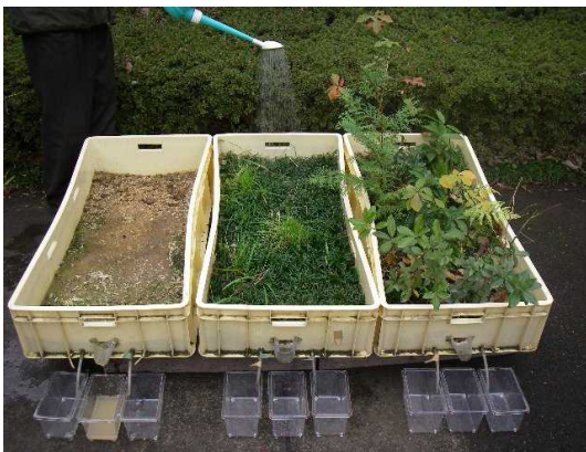
実験装置(ライシメーター)を使用して水が土の中へしみこんでいく様子を観察しよう
