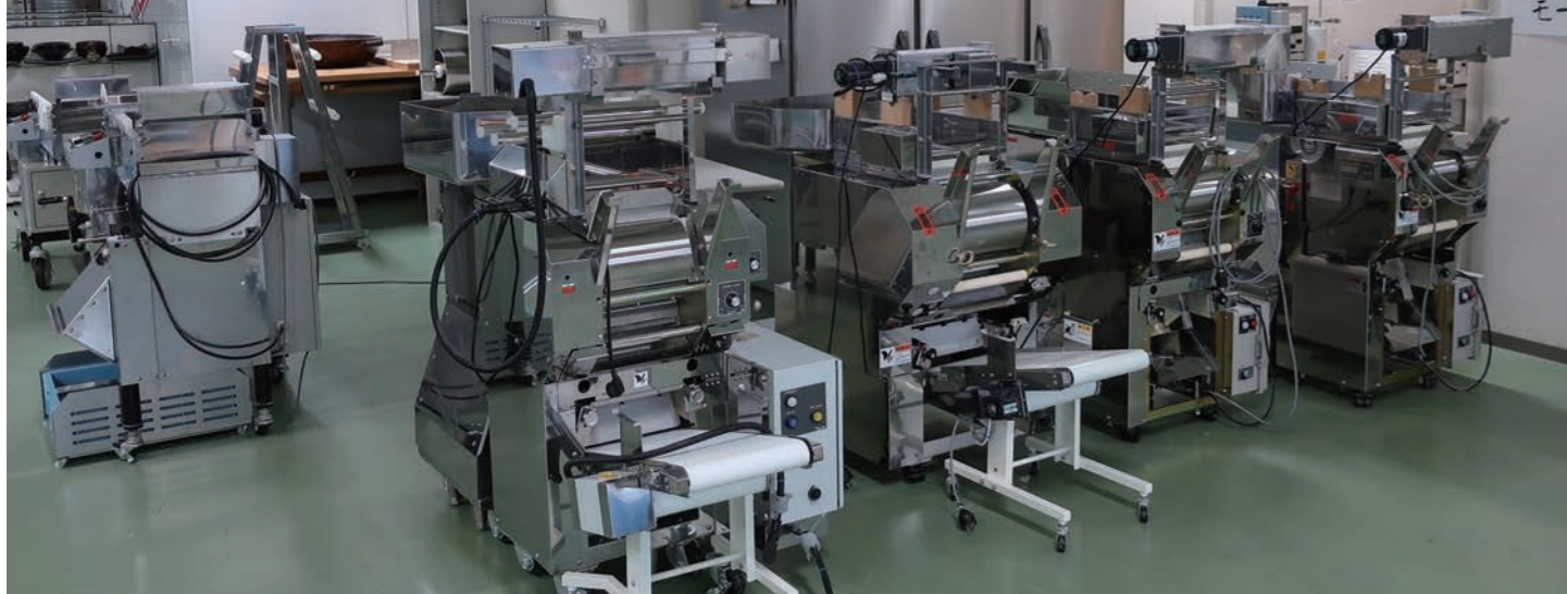
ずらりと並んだ製麺機。実際にお店で使うレシピでテスト製麺し、麺の仕上がりを確かめた上で、丁寧にクリーニングしてから納品する
