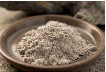
庵治石の粉は釉薬にも使用する。讃岐の風土を思わせる優しい色合いを生み出している。
