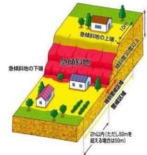
急傾斜地の崩壊
