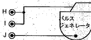
図 138 - シングルチャネル単極パルスジェネレータへの接続
