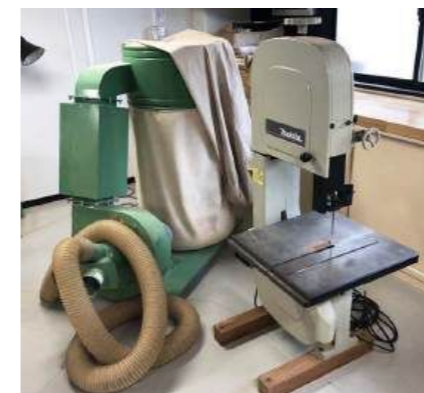
移動式集塵機(左) 各種機械に直接つなぎ、おがくずや木端を吸い込む装置です。
