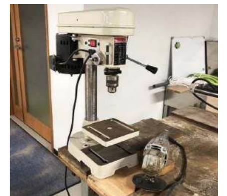
卓上ボール盤(左) 小型なので位置精度も形状精度も良好な穴加工を行うことができます。
