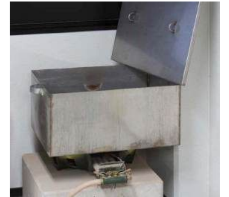
ガス台・ステンレス窯 竹を熱湯に入れて煮込み、油分を抜く「油抜き」作業用のガス台と窯です。
